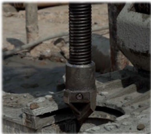
Буровая штанга с долотом, монитором и форсункой
