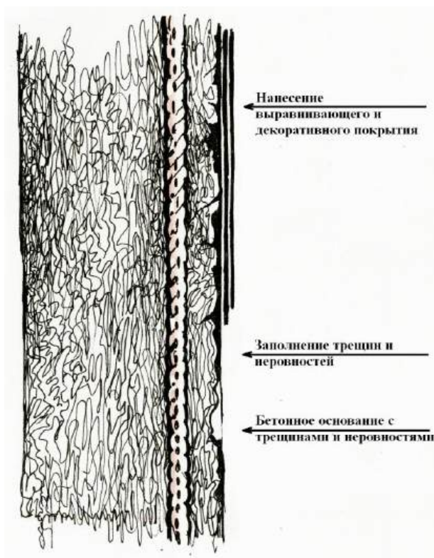
Рисунок 7.18 – Выравнивание бетонной поверхности с целью профилактической защиты арматурного каркаса от коррозии
