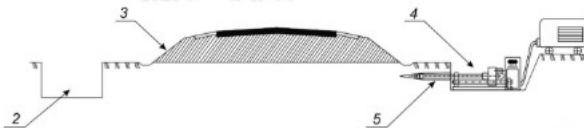
б) Пересечение автомобильной дороги методом прокола
