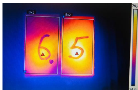
Образец №5 T_{\text{сред}} = 81,6 T_{\text{макс}} = 60,7 Образец №6 T_{\text{сред}} = 50,5 T_{\text{макс}} = 72,0
