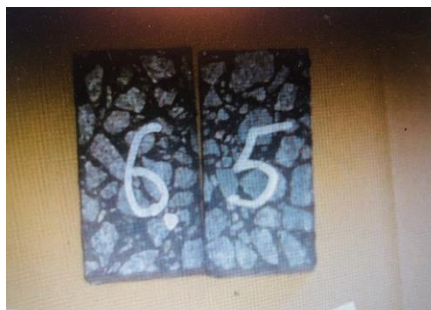
Радиопоглощающий асфальтобетон, обр. 5 и 6
