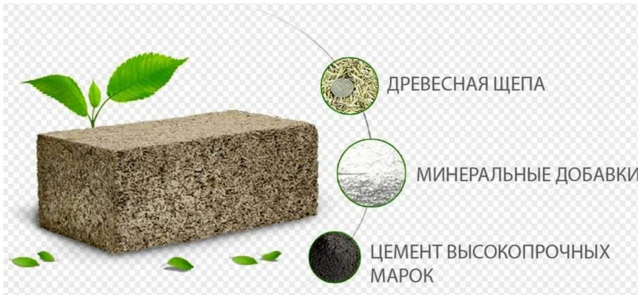
Большое значение имеет **древесное сырье**: размер щепы – **не более 25 мм в длину и 10 в ширину, определенная степень шероховатости**. Лучшие породы дерева – хвойные: **ель, сосна**, а также **бук**. Важен и характер древесины – ранняя или поздняя, **поздняя предпочтительнее**. При соблюдении всех требований и норм ГОСТ материал получается легкий, «дышащий», пористый, но при этом достаточно прочный.
